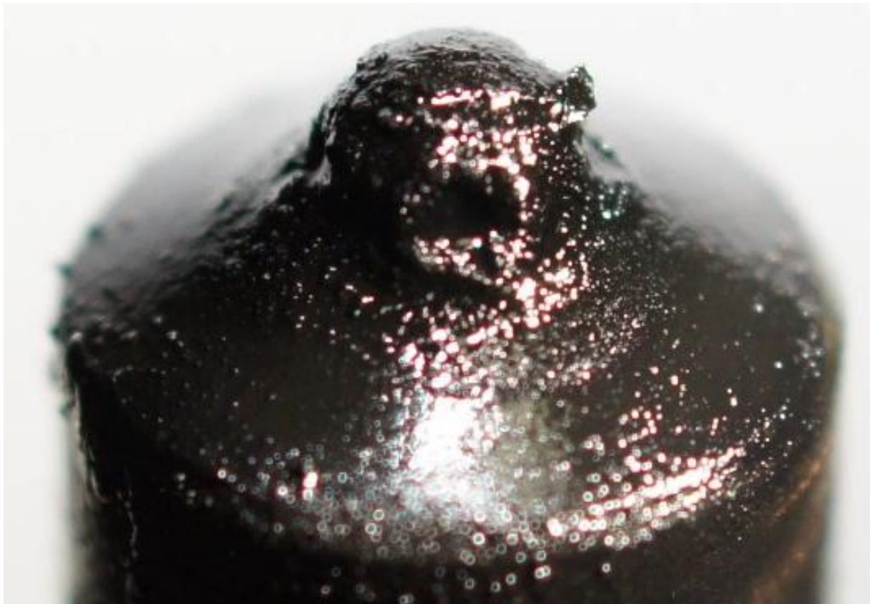
Rys.10. Mokry rozpylacz po teście zakoksowania – olej napędowy BEZ REDUXCO
