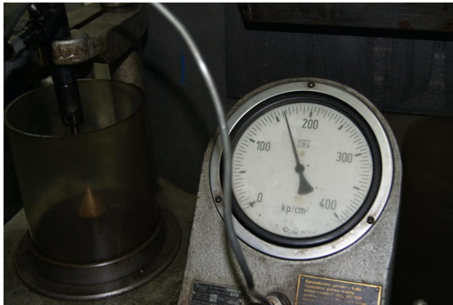
Rys.5. Widok ogólny stanowiska do pomiaru statycznego ciśnienia otwarcia wtryskiwacza paliwa
