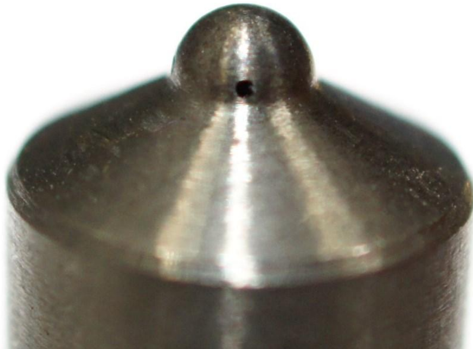
Rys. 9. Czysty rozpylacz paliwa (otwory wylotowe 4 x \phi 0,35 mm) – powiększenie 23x
