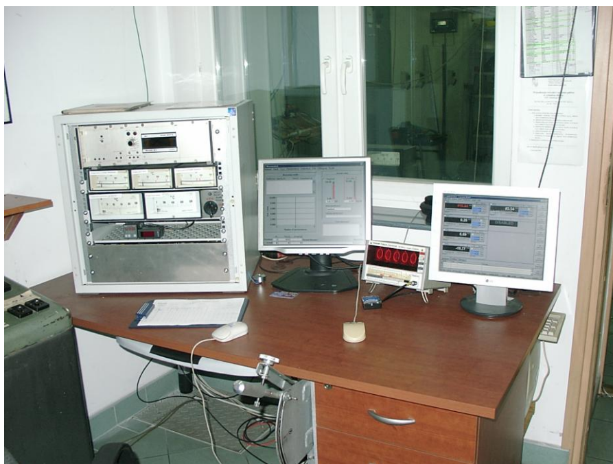
Rys.2.. Widok ogólny stanowiska badawczego (sterownia silnia badawczego) do określania stopnia zakoksowania rozpylaczy zasilanego olejem napędowym oraz testowanym paliwem
