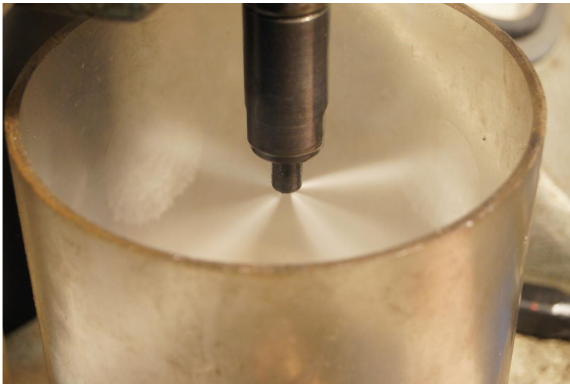
Rys.6. Widok ogólny stanowiska do oceny jakości i położenia strug paliwa z rozpylacza
