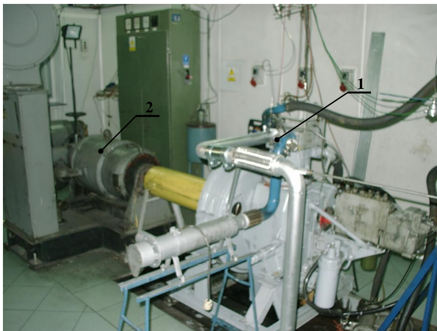
Rys.1. Widok ogólny stanowiska badawczego (z 1-cylindrowym silnikiem wysokoprężnym) do zrealizowania testu badawczego zakoksowania rozpylaczy
